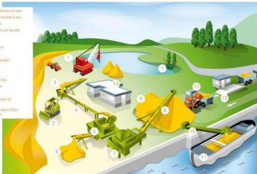
Schéma d'exploitation d'une carrière alluvionnaire
